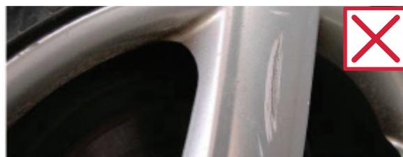
Déformation visible ou rayures mesurant plus de 10 cm sur les bords de jante ou 3 cm sur les bâtons.
