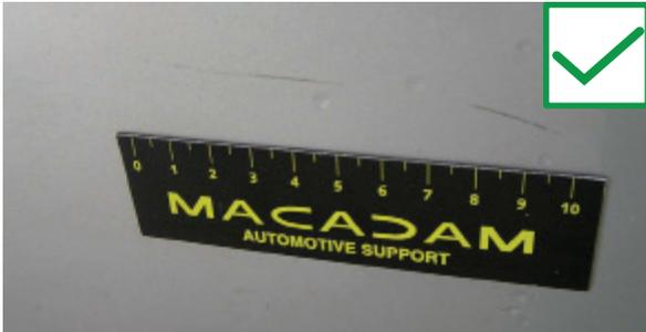
Rayures superficielles de la peinture qui ne nécessitent aucune réparation et peuvent être éliminées par polissage.
