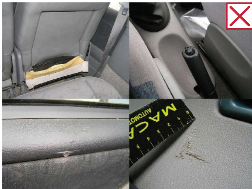
Déchirures ou éraflures des matériaux quels qu'ils soient à l'intérieur du véhicule.
