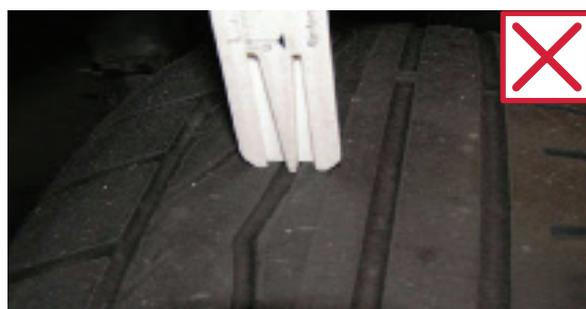
Usure du pneu supérieure à 60 % (soit une épaisseur restante strictement inférieure à 4,2 mm).
