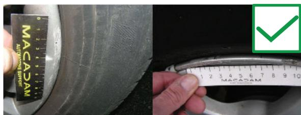
Les roues et les enjoliveurs doivent être en bon état. Un dommage sur une jante alliage est accepté à condition que la ou les entailles mesurent moins de 10 cm sur le bord et moins de 3 cm sur les bâtons.
