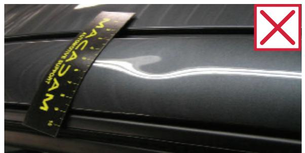
Bosse sans dégât de peinture, mais d'un diamètre de plus de 20 mm ou d'une profondeur supérieure à 2 mm. Petites bosses de moins de 2 mm de profondeur et de moins de 20 mm de diamètre, sans dégât sur la peinture, mais dont le nombre est supérieur à 2 par panneau.
